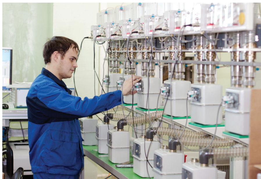
Рис. 3. Работа на поверочной установке QRM
