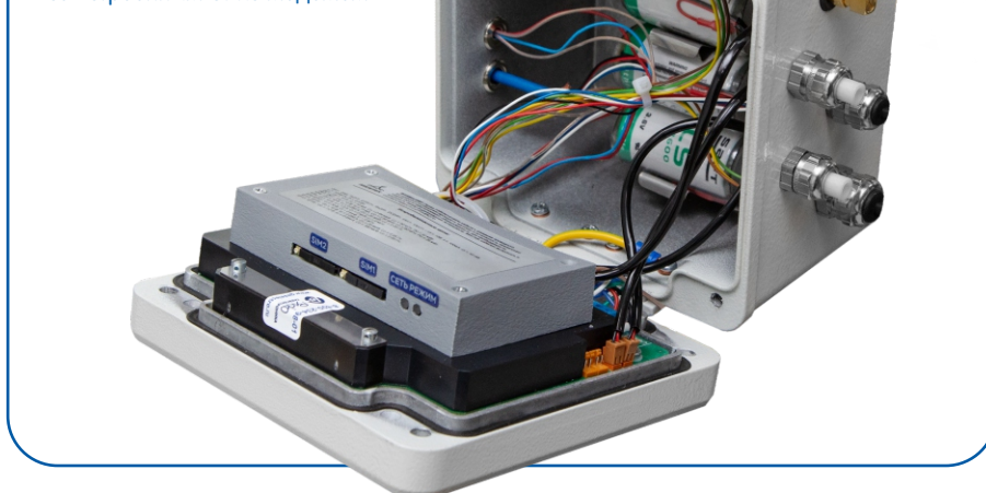
Электронный корректор ЕК270 со встроенным GPRS модемом
